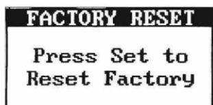
در این منو می توان تنظیمات دستگاه را به حالت کارخانه بازگرداند. با این کار تمامی پارامتر ها و پسورد دستگاه به حالت پیشفرض بر میگردد. برای این کار ابتدا کلید SET را فشار دهید سپس پسورد را وارد کرده و منتظر باشید تا دستگاه RESET شود.
